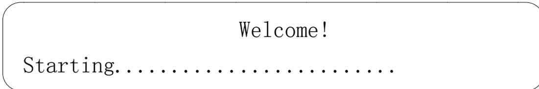
等待 30S 左右，设备进入系统，LCD 上排显示设备类型，设备型号。下排滚动显示设备的网络信息、连接状态、运行状态等。
